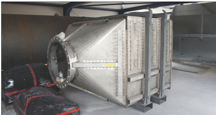
Mit der komplett betriebsbereiten, vollautomatischen SCR-Katalysator-Anlage inklusive Harnstoffeindüsung (Adblue) entsprechen die ETW-Anlagen dem neuesten Stand der Technik und unterschreiten damit alle aktuell geforderten Abgasgrenzwerte.
